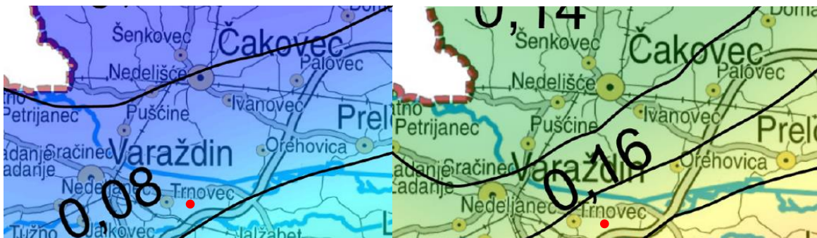
Slika 14. Približan položaj lokacije zahvata (crveno) sukladno Karti potresnih područja za povratno razdoblje 95 godina (lijevo) i 475 godina (desno), Izvor: http://seizkarta.gfz.hr , 2022.
